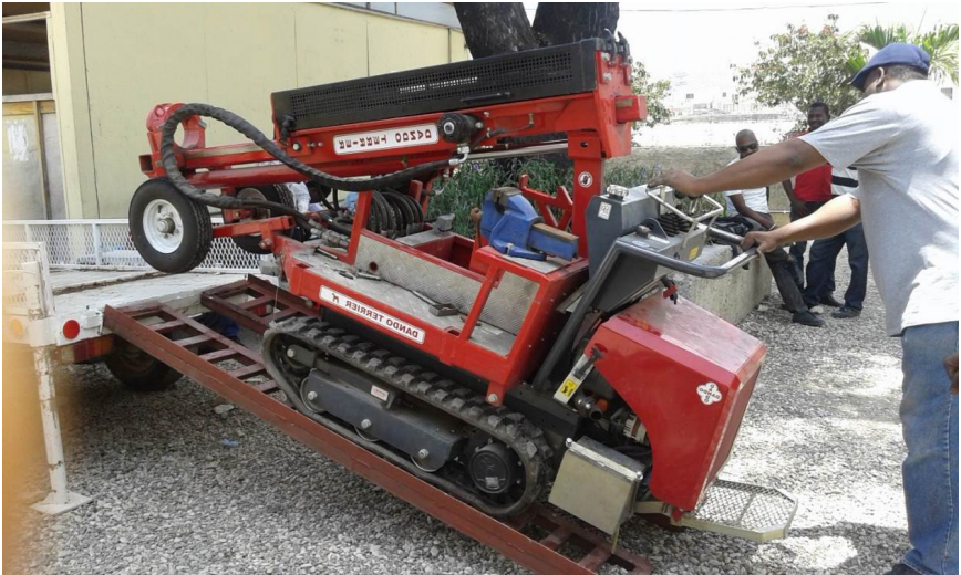
Foreuse portable de l'URGéo sans mât déployé
