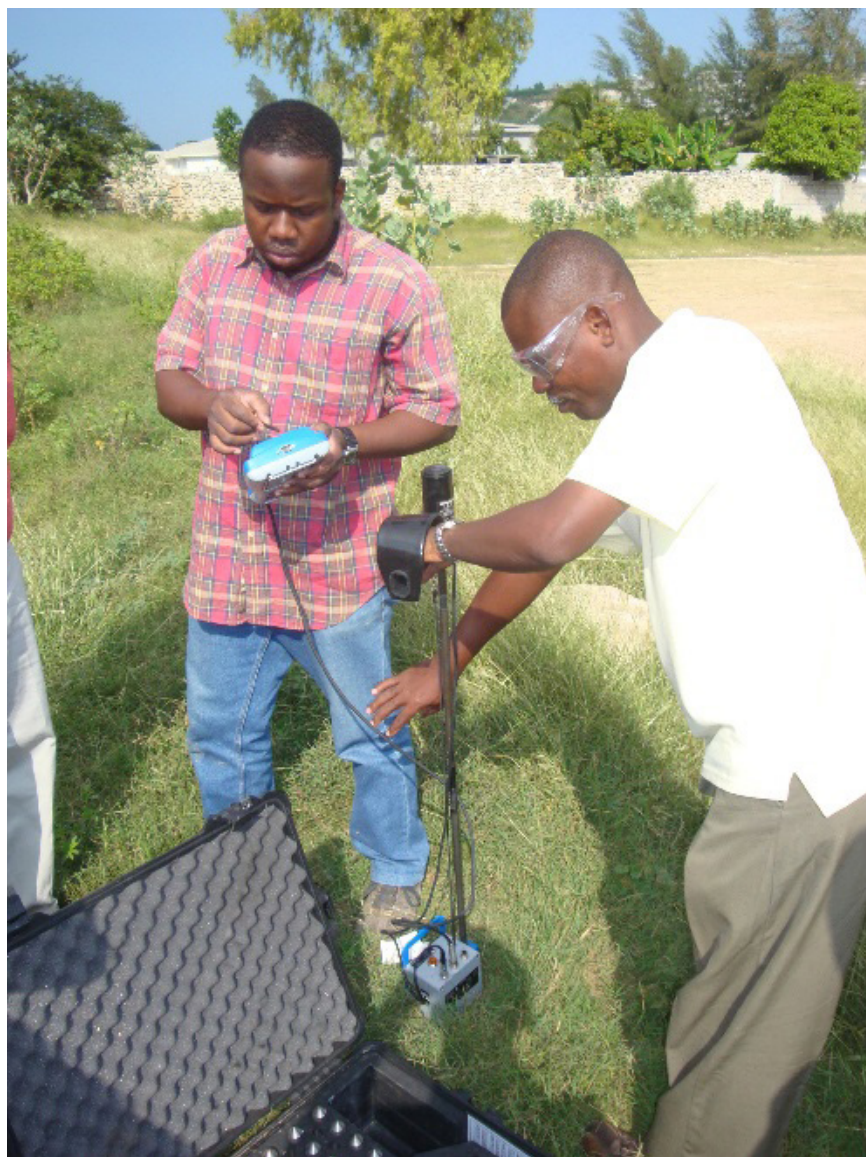
Essai au Pénétrmètre dynamique (Panda)
